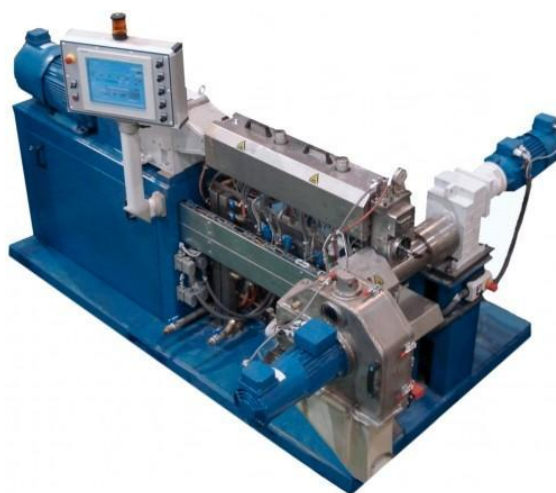
Рис. 2.1. Двухшнековый экструдер Thermo Haake, модель Reomex RTW 25/42
