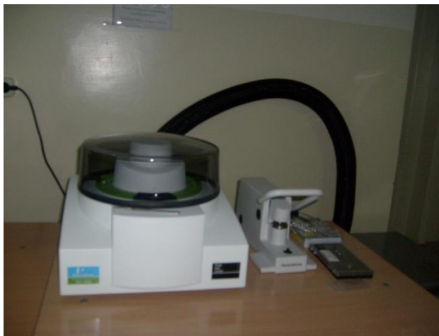
Рис. 2.6. Дифференциальный сканирующий калориметр Perkin Elmer, модель DSC 4000
